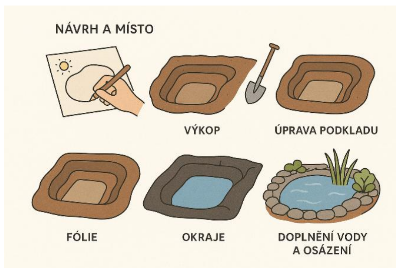
Obrázek 31: Zjednodušený návrh a postup budování zahradního jezírka.
